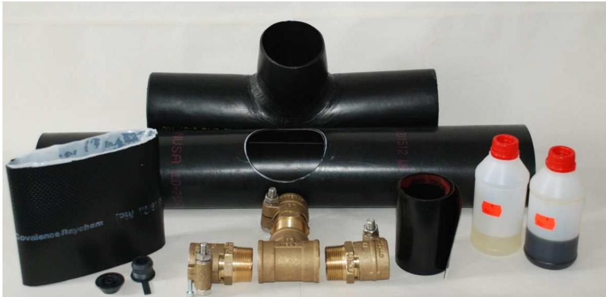
Der Satz zur Wärmedämmung besteht aus: einem T-Stück aus Polyethylen, Schrumpfband, Schrumpfmanschette mit Verschlussband, Schweißstopfen, Komponenten des PUR-Schaumes. Die Übergangskupplungen HELA für die T-förmige Abzweigverbindung werden je nach Außendurchmesser und Wandstärke des PEX-Mediumrohres gewählt.
