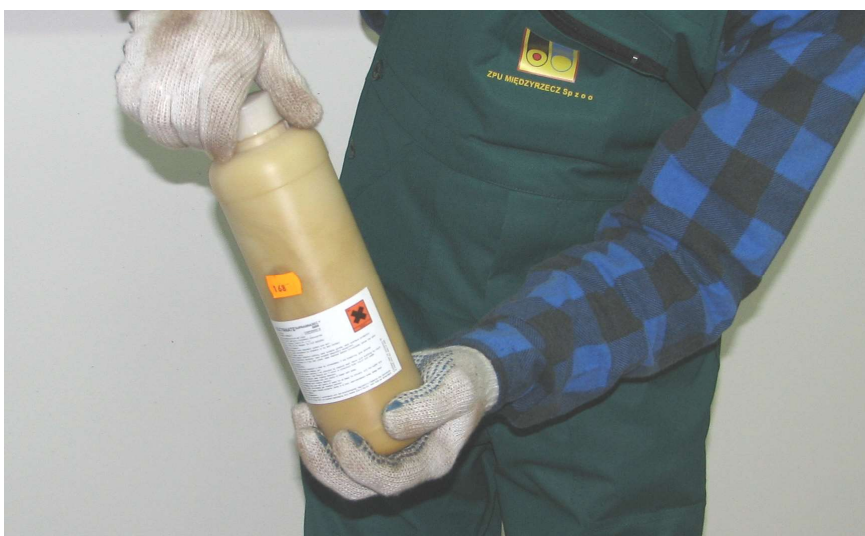
Fot. Nr 48 Mieszanie składników A i B pianki PUR.
