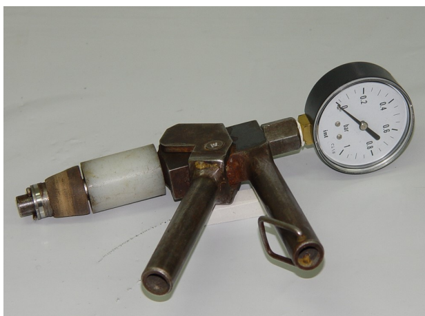
Fot. Nr 11 Manometr kontrolny z korkiem rozprężnym
