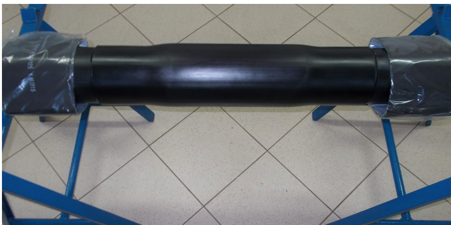
Fot. Nr 31 Widok nasuwki termokurczliwej po obkurczeniu.
