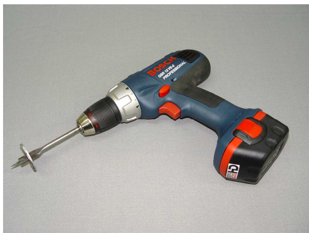
Fot. Nr 9 Wiertarka akumulatorowa z wiertłem do wiercenia otworów wlewowych o średnicy 25 mm
