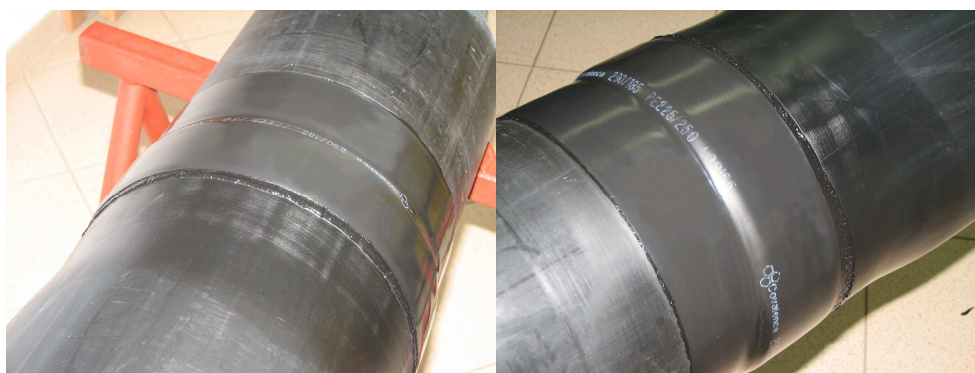
Fot. Nr 45 i 46 Widok opaski termokurczliwej po obkurczeniu z widocznym spoiwem na całej długości jej krawędzi.
