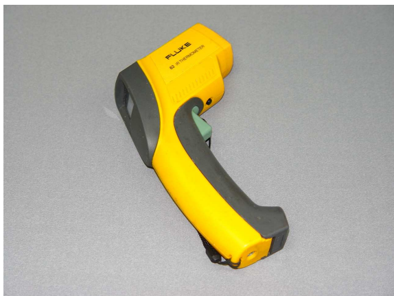
Fot. Nr 7 Pirometr do pomiaru temperatury nasuwki termokurczliwej - zalecany
