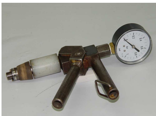
Fot. Nr 11 Manometr kontrolny z korkiem rozprężnym
