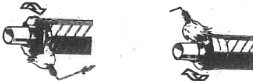
Obkurczanie rękawa po stronie rury osłonowej.
