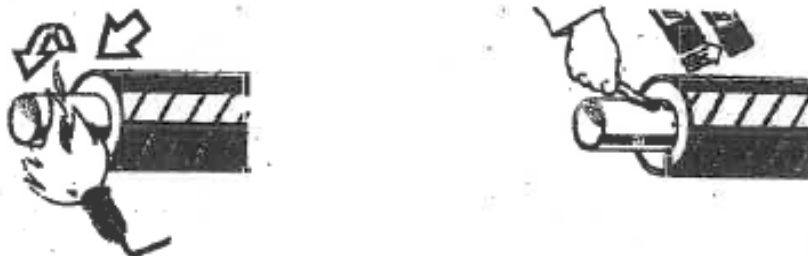
Podgrzanie rury przewodowej (60°C) oraz osłonowej (40°C)
